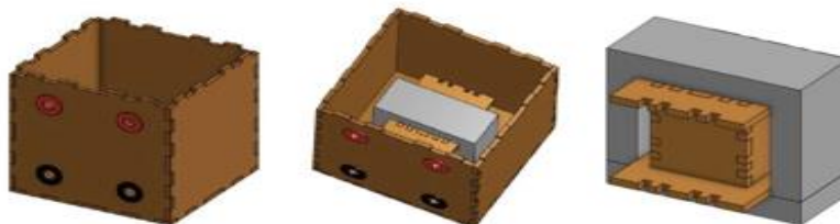
Figura 8: Prototipo 3D del transformador monofásico
