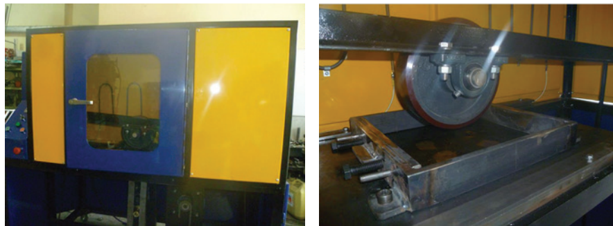
Figura 7. Equipo construido según norma INVIAS 756-13 para la determinación del ahuellamiento de mezclas asfálticas 1
