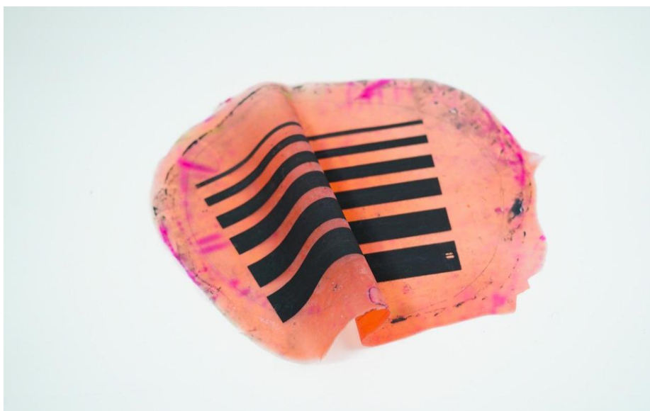
Figura 1. Biomaterial PROM1 serigrafiado con seis líneas de tinta conductiva, formulación T1. El largo de cada línea es L=250 mm, y el ancho A varía entre 5 mm y 30 mm, con un paso de 5 mm.
