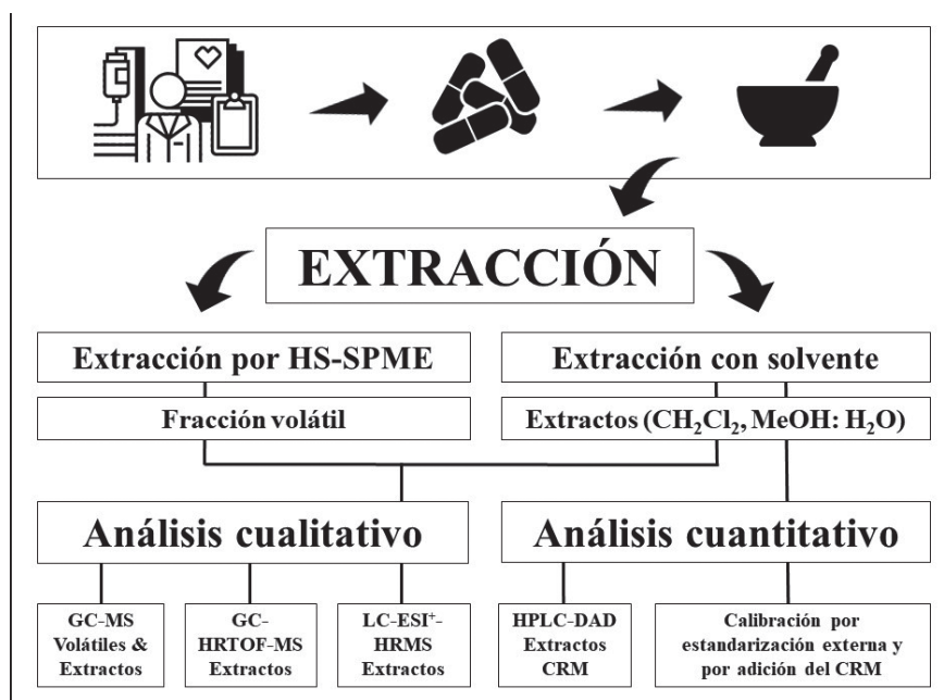
Figura 1. Esquema general de las etapas de la adquisición del producto fitoterapéutico a base de caléndula ( Calendula officinalis ), la preparación de la muestra, las extracciones (HS-SPME y con solventes orgánicos) y los análisis de fracciones volátiles y extractos por diferentes técnicas de cromatografía de gases (GC), líquida (LC) y espectrometría de masas de baja y alta resolución (MS y HRMS).
