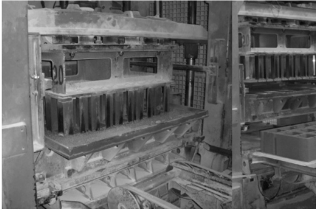
Figura 1. Equipo de fabricación de bloques en la planta de prefabricados.
