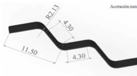
FIGURA 10. Dimensiones promedio de la ondulación generada en la tira plástica.
