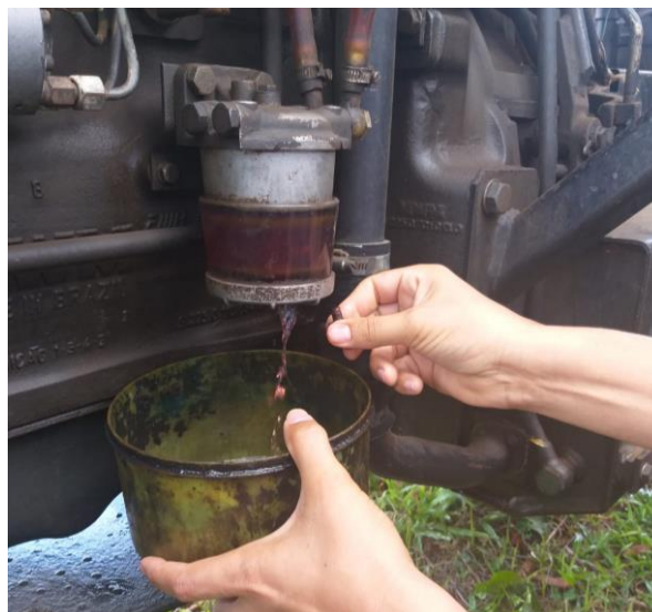
Figura 4- Drenagem do conteúdo indesejável retido no copo sedimentador.
