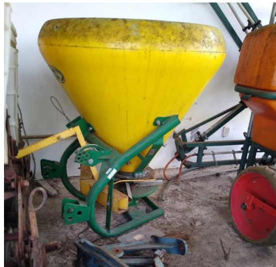
Figura 11- Distribuidor volumétrico centrífugo.
