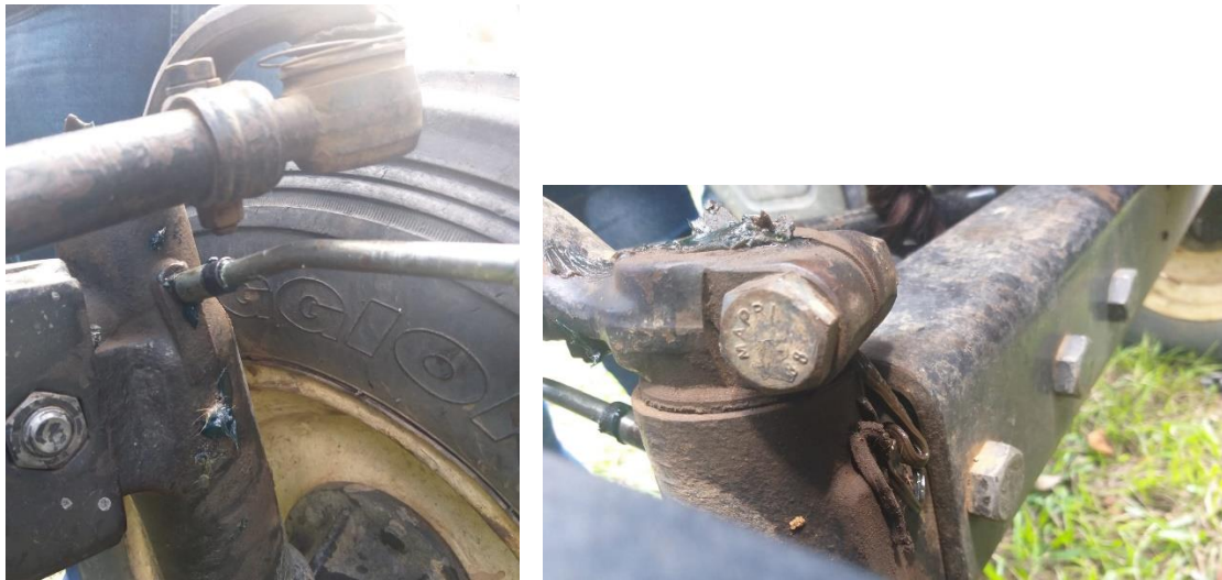
Figura 6- Reposição do óleo lubrificante novo e a saída do óleo usado
