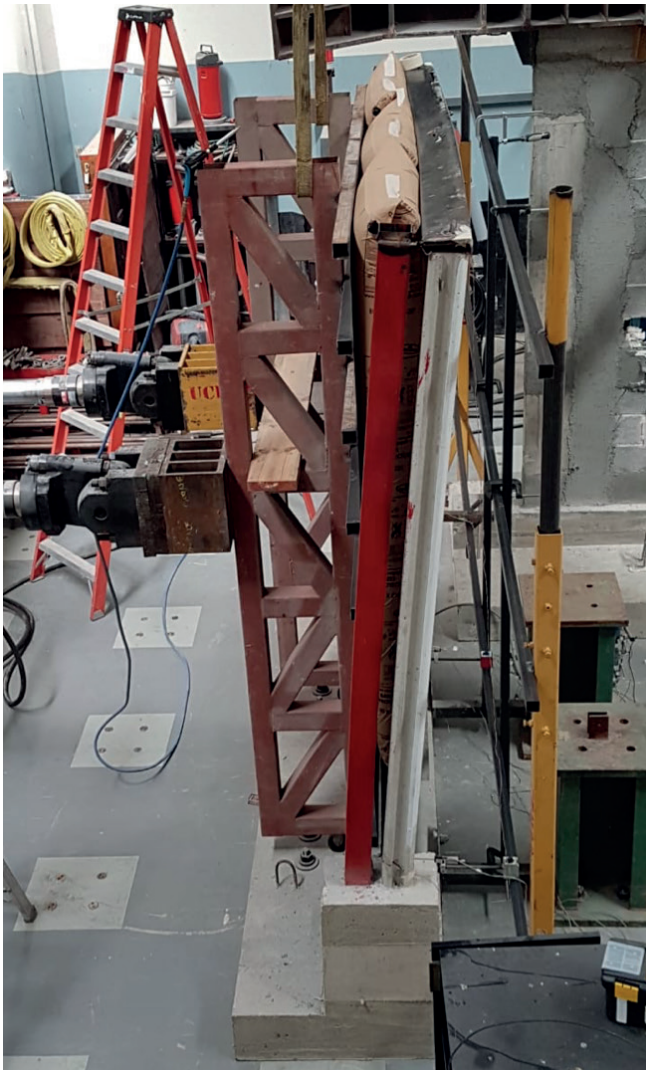
Figura 6. Fotografía del ensayo con bolsas de aire
