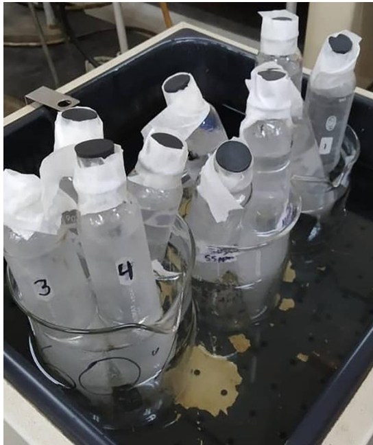
Fig. 2. Montaje experimental de la prueba de eficiencia mediante la norma NACE TM 0374 – 2007 [17] Fuente: elaboración propia.
