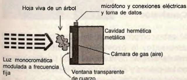
Figura 3. Esquema de una celda fotoacústica abierta.
