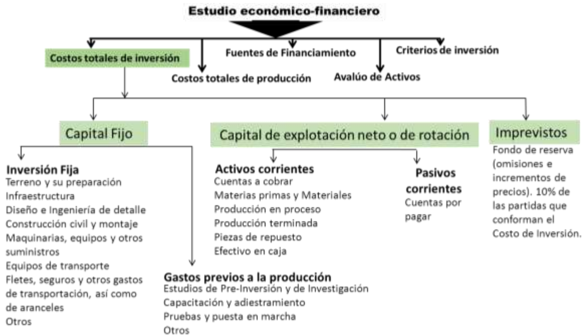
Figura 1. Componentes de los costos totales de inversión en los estudios de factibilidad técnico-económica
