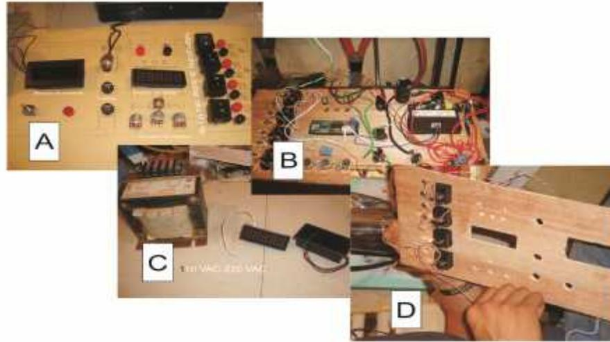
**Figura 1.** Pasos del armado del equipo de resistividad: A) diseño previo del equipo antes de conjuntar todos los dispositivos electroditos, B) unión de todos los dispositivos electroditos, C) convertidor de corriente 110 VAC a 220 VAC, y madera donde se montaron todos los aditamentos electrónicos.
