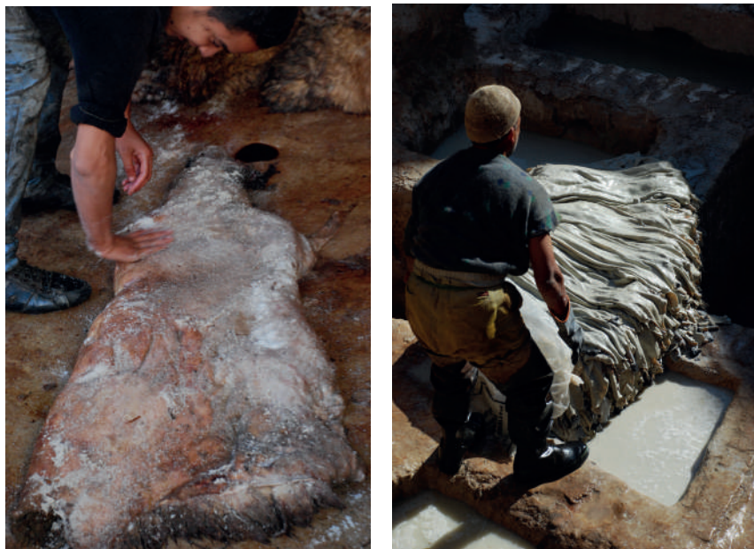
Figs. 3 y 4.—Imágenes de una curtiduría de la ciudad de Fez donde todavía se preparan las pieles de manera artesanal. A la izquierda aplicándoles sal y a la derecha sometiendo las pieles a baños de cal. Autora: Elena Vázquez Jiménez.
