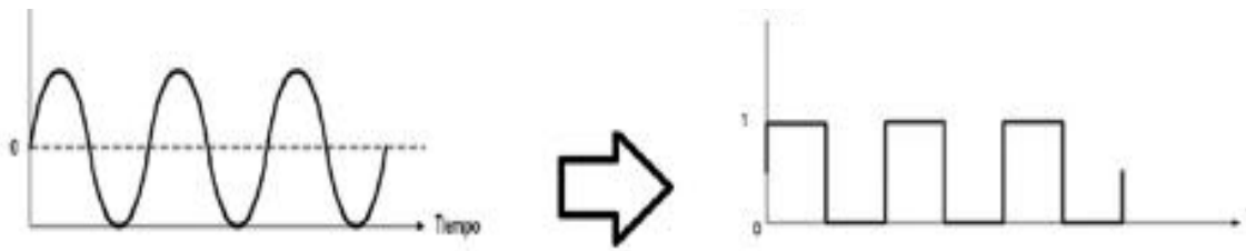
Figura 13. Figura demostrativa de una señal analógica a digital. Fuente: Elaboración propia.
