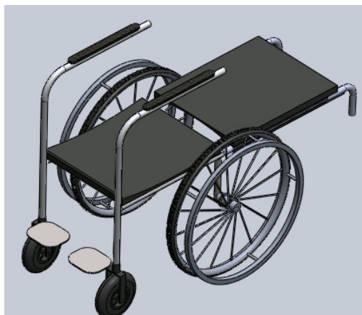
Figura 2. Modificaciones de elevación y caída hacia atrás del espaldar, con soporte a tierra para evitar el desbalance de la silla.
