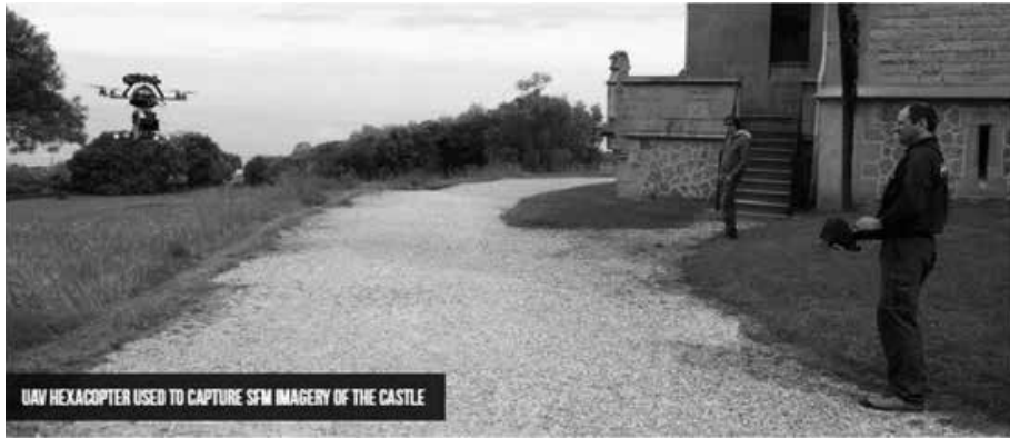
Fig. 15. Fotogrametría aérea con uso de drones. Proyecto ABBADIA CASTLE.
