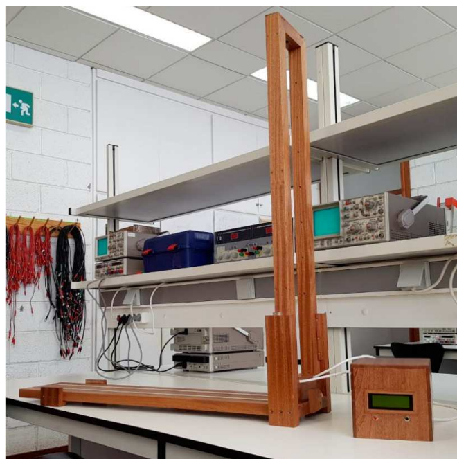
a.- Disposición para el estudio del movimiento en el plano vertical
