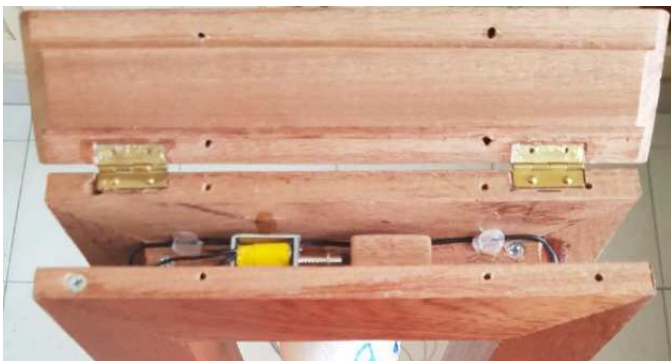
Figura 6. Detalle del dispositivo de liberación de la bola
