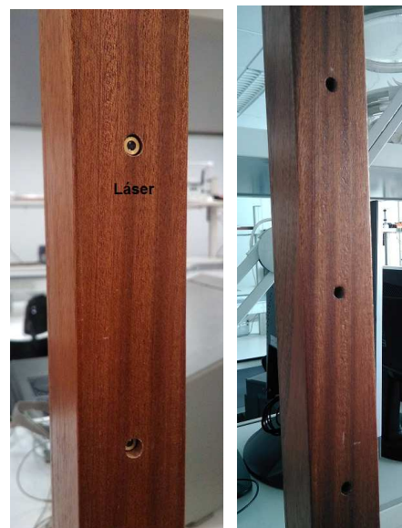
Figura 8. Situación de láseres y fototransistores en la pieza A
