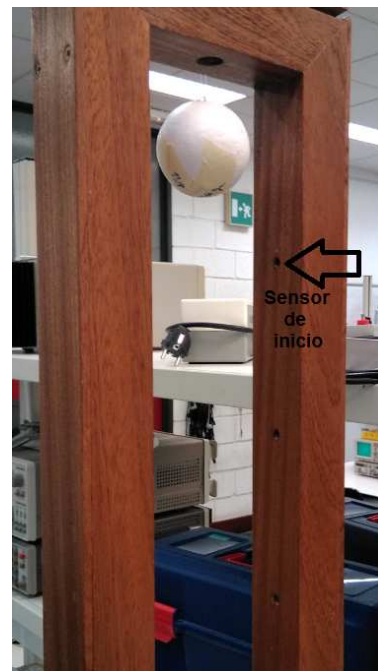
Figura 3. Situación del dispositivo de liberación de la bola/carrito y del sensor de inicio de medida del tiempo
