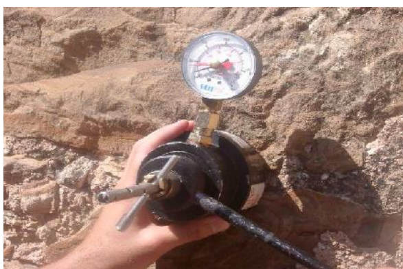
Fig. 7 – Ensaio de arrancamento numa hélice.
