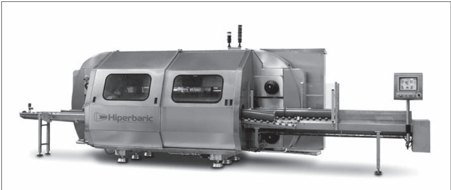
Figura 4. Imagen de uno de los equipos de altas presiones de CICYTEX (Imagen cedida por Hiperbaric).
