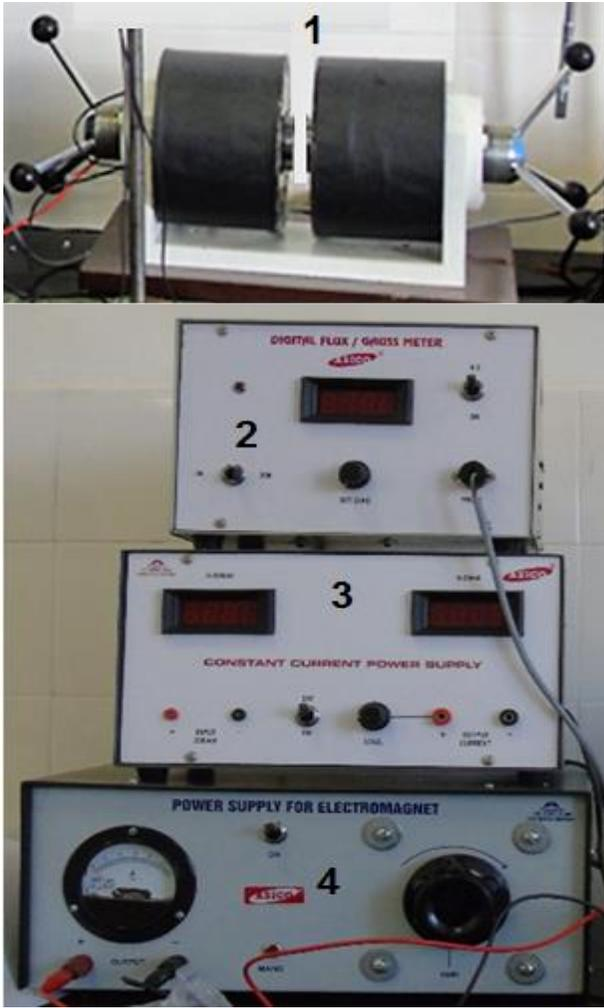
FIGURA 3. Equipos que integran el montaje para el estudio del efecto Hall: electroimán 1, gaussímetro 2, fuente estabilizada de alimentación de corriente constante 3, fuente de alimentación para el electroimán 4.
