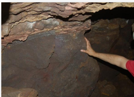
Fig. 5.- Veta de mineral con alto contenido de hierro al interior de la galería.
