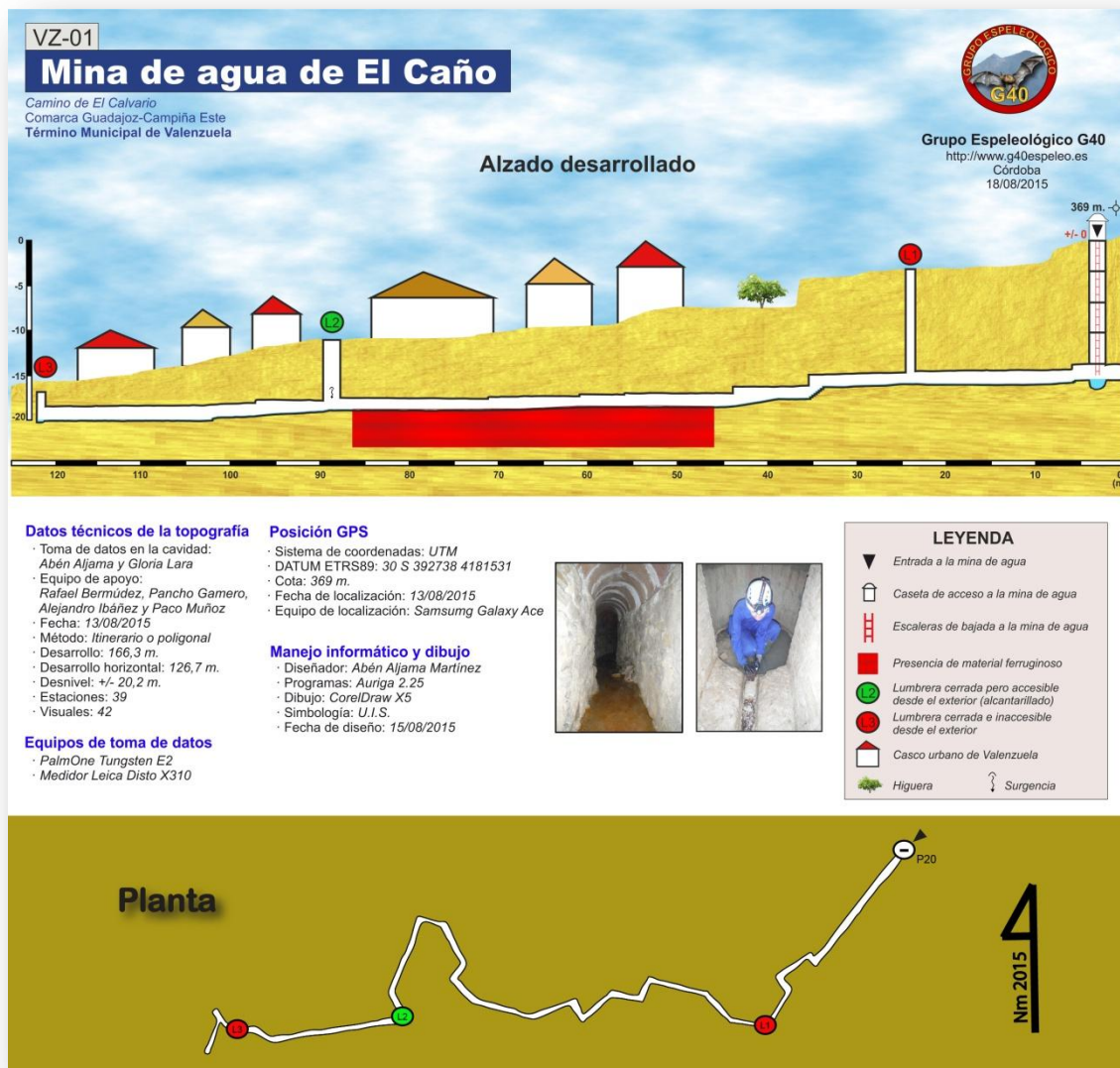
Fig. 14: Topografía de la Mina de agua de El Caño. Realizada por miembros del G40
