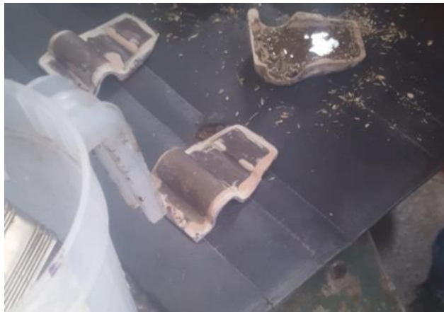
Figura 5. Aplicación de las capas de fibra de carbono.
