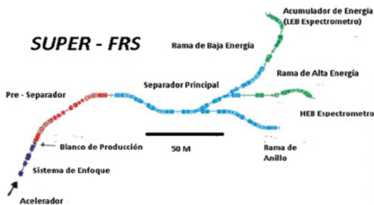
Fig. 4. ESQUEMA GENERAL DEL SUPER-SEPARADOR DE FRAGMENTOS (SFRS)
