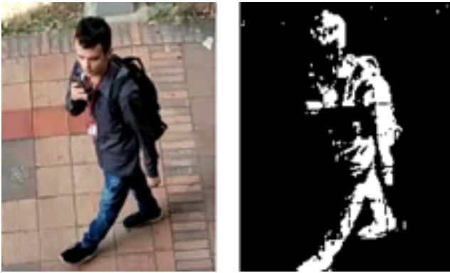
Figura 11. Imagen con aplicación de la técnica de sustracción de fondo y extracción de blobs.
