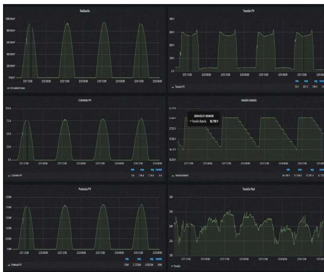
Fig. 8. Pantalla donde se muestran algunas de las variables adquiridas.
