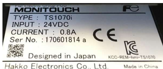
Fig. 6. Datos técnicos del circuito de alimentación de la interfaz que monitoriza y configura el variador de velocidad.
