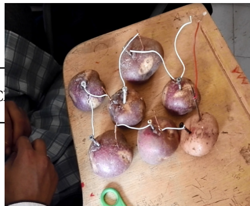
Figura 2. Fuente de energía con papas. Fuente: elaboración propia.
