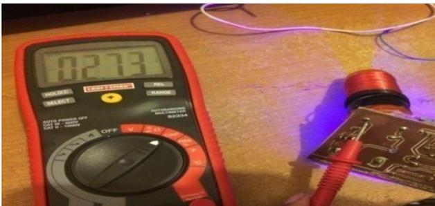
Figura 5. Medición de la capacitancia parasita.
