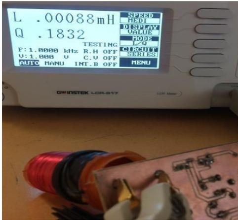
Figura 4. Medición de la inductancia de la bobina primaria.
