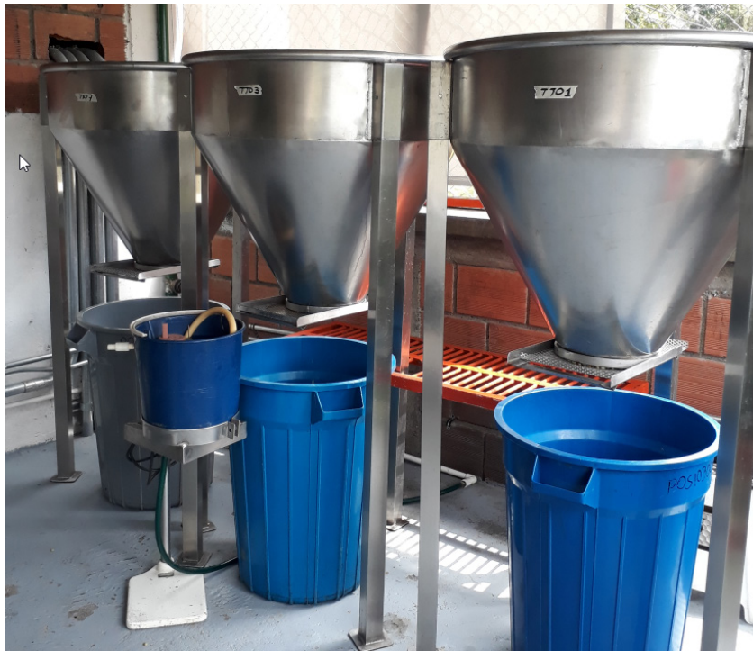
Figura 1. Montaje experimental con tanques de fermentación en acero inoxidable para la aplicación de tratamientos.
