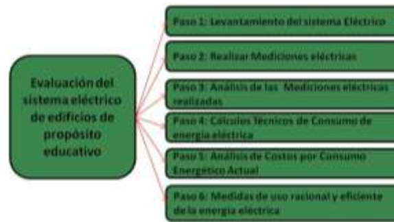
Figura 1: Diagrama del modelo de Evaluación del sistema eléctrico de un edificio de propósito educativo
