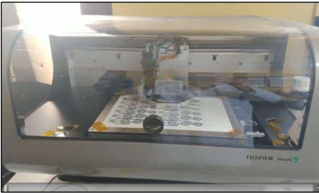
Fig. 9. Práctica de impresión inkjet de patrones conductivos sobre tela de algodón. Se emplea la DIMATIX DMP-2850 con tinta de nanopartículas de plata y un cartucho de 16 nozzles, en simple columna y 10 pL de volumen con una resolución de 100 dpi.
