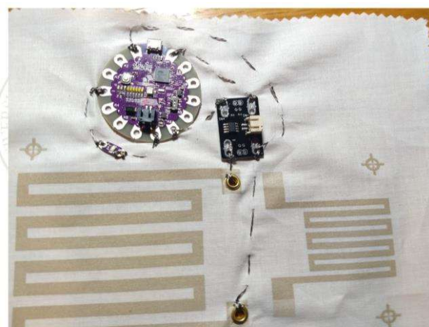
Fig. 8. Práctica de control de un calefactor en textil mediante todo/nada y PWM.
