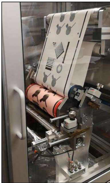
Fig. 11. Práctica de flexografía de patrones conductivos sobre tela de algodón. Se emplea una KPP de una unidad de impresión de flexografía. La tinta flexográfica es de plata.
