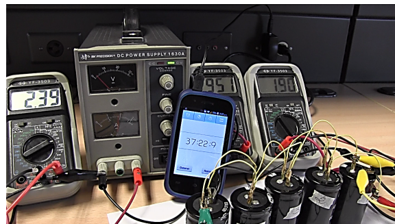
Figura 5: Circuito de carga y descarga con los ultracondensadores en paralelo
