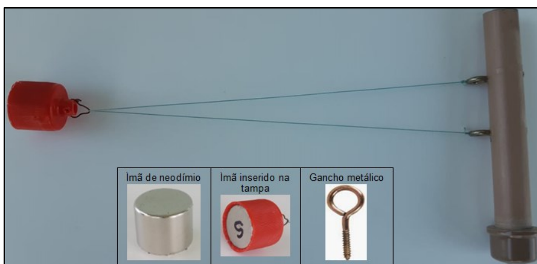
Fig. 3 – Suporte horizontal em PVC com o pêndulo e detalhes do ímã de neodímio, da tampa com o ímã inserido em seu interior e do um gancho semelhante aos fixados no PVC. Fonte: acervo pessoal, 2019.
