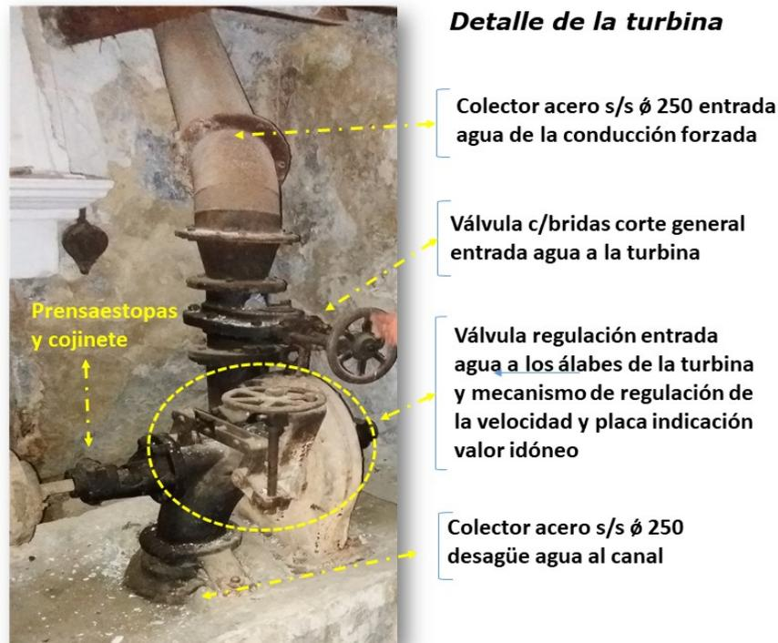
**38. Detalle de los elementos que componen la turbina (2)**
