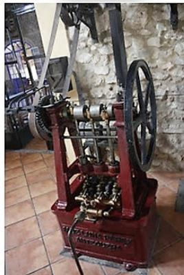
**Caja de bombas accionada por una correa a través del árbol de poleas (Modelo análogo al que estaba instalado en la almazara).**
