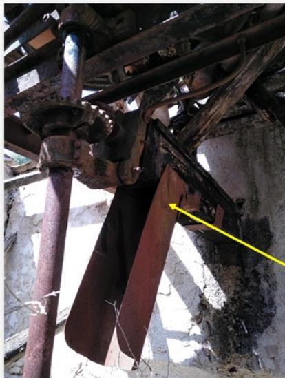
**Detalle del sinfín en el interior de la sala de molienda, y canal de vertido del fruto sobre el empiedro del molino.**
