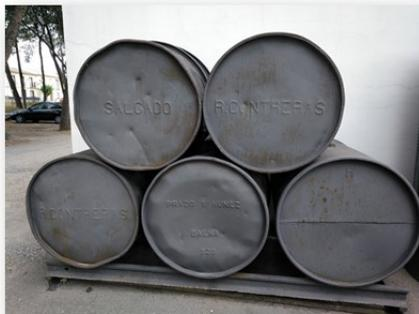
**Modelos de bidones de acero con uniones roblonadas utilizados para el almacén del aceite, análogos a los que estaban instalados en la almazara.
