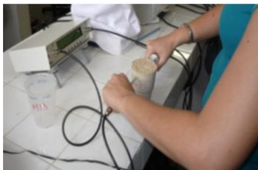
Figura 1. - Equipamiento Steinkamp BP-7 para ensayos con ultra sonido
