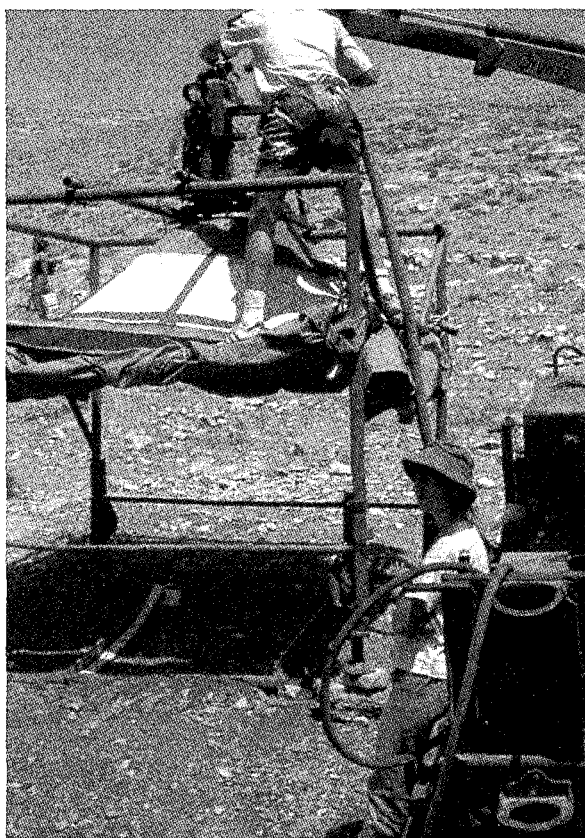
Figura 7. Vista de un simulador de lluvia pulverizador con disco controlador de la intensidad de lluvia (Morin et al., 1967). Fotografía H. Lavee.
