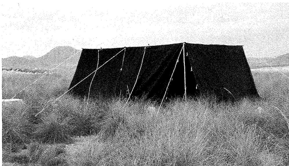
Figura 11. Simulador de lluvia de gran tamaño (parcelas de 5 x 8 m) desarrollado en Holanda (Cerdà, 1995).
