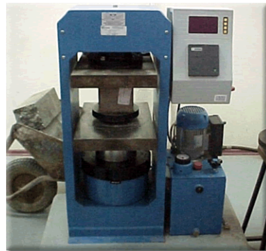
Figura 1. Prensa computarizada para ensayos de compresión.
