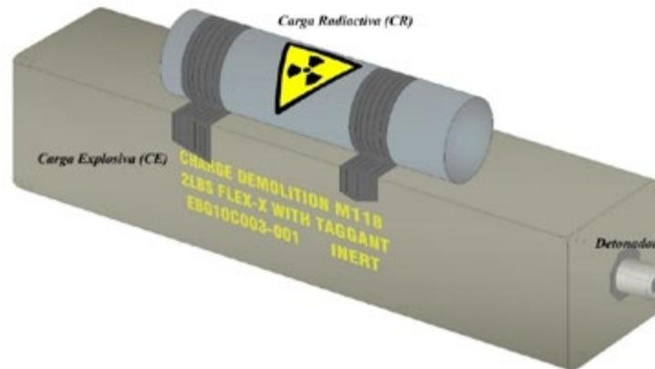
Figura 1. Configuración típica de un RDDe. Fuente. Elaboración propia.
