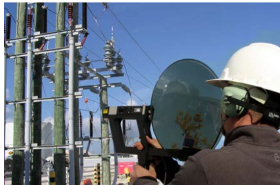
Figura 7. Detección de descargas parciales por ultrasonido
