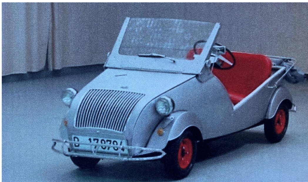
Coche Biscooter, motor Hispano Villiers de un cilindro, 197 cc y dos tiempos 9 CV
