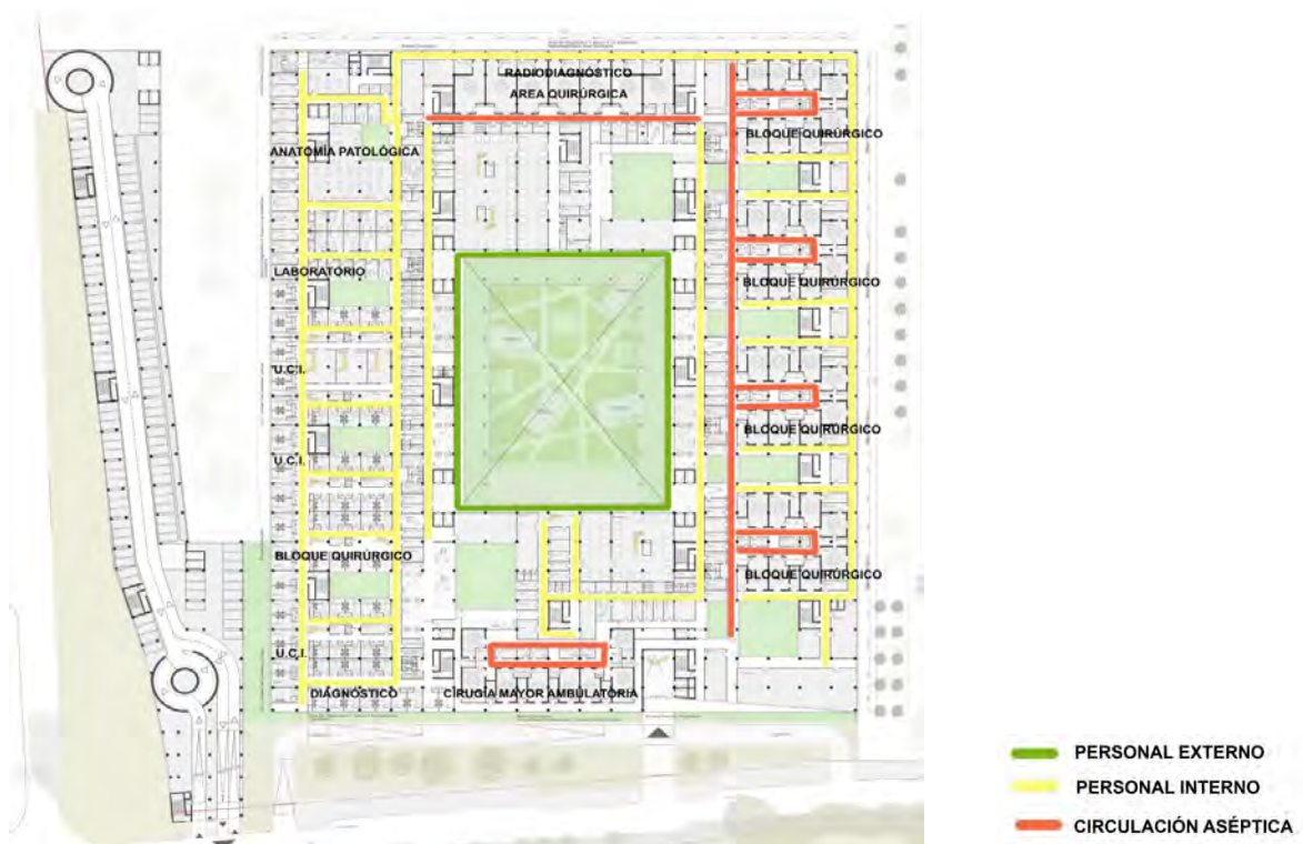
Funcionamiento Planta 2ª.
