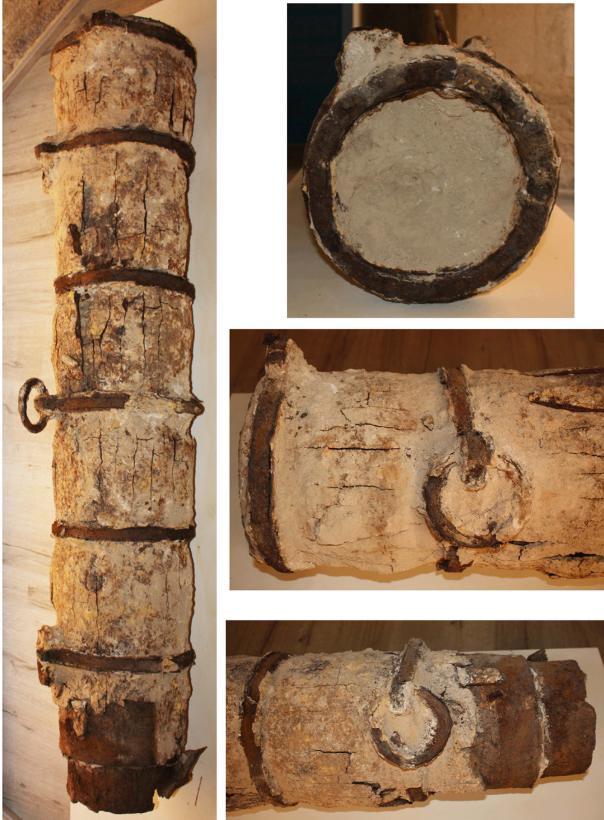
Fig. 4.- Detalles de la caña de bombardita del Castillo de Chinchilla
