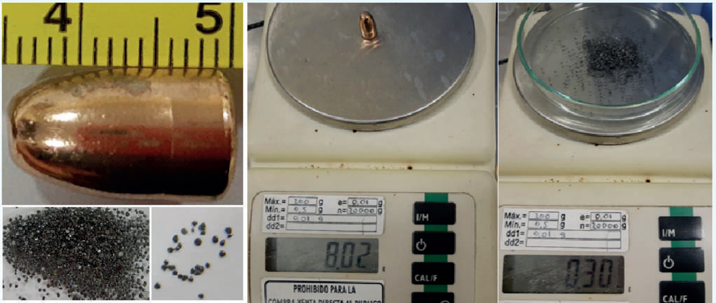
Fig. N° 3. Izq. arriba: Punta del cartucho de recarga Waffens. Izq. abajo: Fotografía en detalle de los granos de pólvora presentes en el cartucho de recarga. Centro: Peso de la punta. Derecha: Cantidad total de pólvora en gramos.
