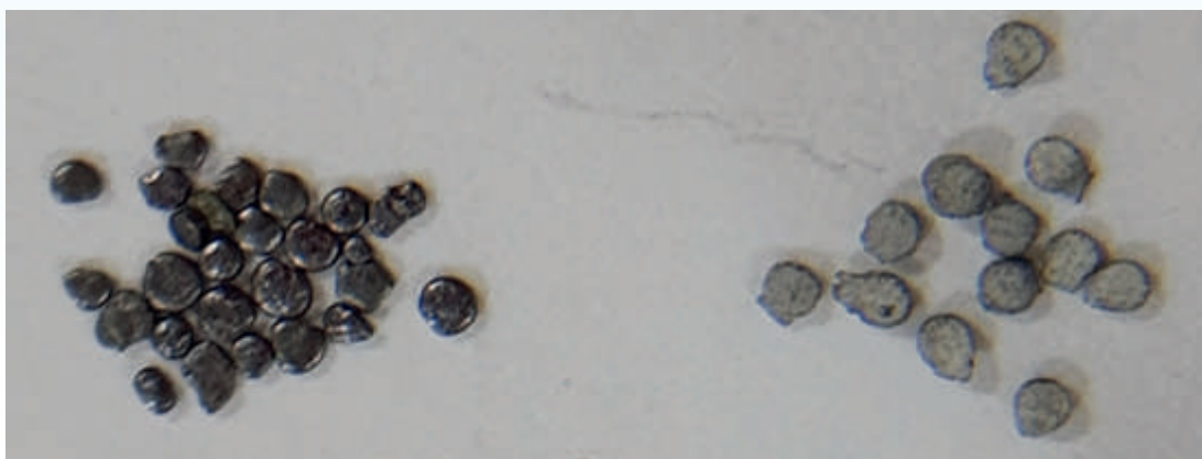
Fig. N° 5. Pólvora del cartucho de recarga (izquierda) y pólvora del cartucho de fábrica (derecha).
