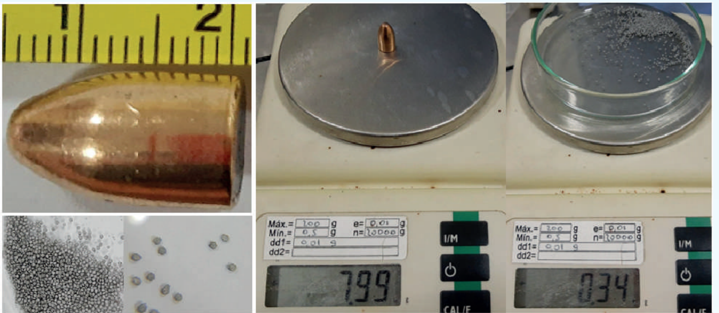
Fig. N° 4 Izq. arriba: Punta del cartucho Factory. Izq. abajo: Fotografía en detalle de los granos de pólvora presentes en el cartucho de fabrica. Centro: Peso de la punta. Derecha: Cantidad total de pólvora en gramos.
