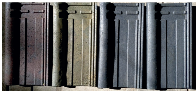
Figura 2. Tejas con óxidos color rojo, amarillo, verde y azul. Fuente: elaboración propia.
