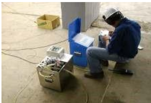
Fig1. Toma de datos de los gases de chimenea del horno PH1 (300189).
