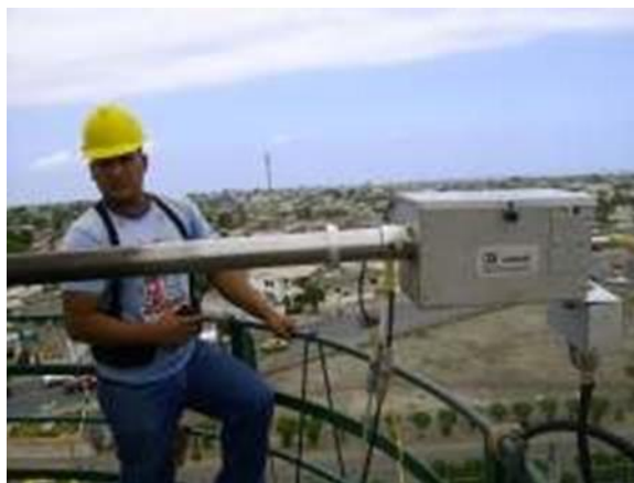
Fig. 3 Equipo (LAPES), analiza sólidos en los gases de chimenea del horno PH1
