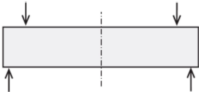
Figura 2. Ejemplo de una probeta a flexión. La línea punteada marca la sección de interés para generar la tabla de búsqueda.
