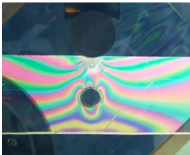
Figura 1. Ejemplo de un material birrefringente al esfuerzo visto a través del arreglo óptico del polariscopio.
