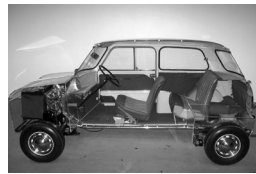
Sección de un Mini, en la que se aprecia su excepcional aprovechamiento del volumen: 20% para el motor y 80% para el equipaje y los pasajeros (imagen tomada de Internet).
