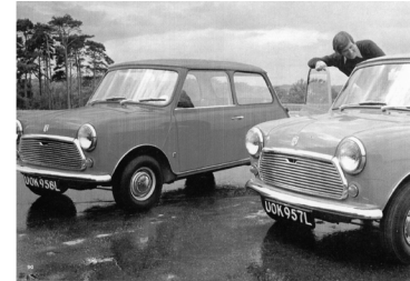
El Mini MkIII llegó a los dos años del MkII de la mano BLMC (British Leyland Motor Company), grupo formado en 1968. Los cambios más destacados fueron la eliminación de las bisagras exteriores de las puertas, la sustitución de las ventanillas delanteras correderas por descendentes y el cambio de las manecillas de las puertas (de forma y de colocación). Hasta su cese de fabricación en el año 2000 las principales características del exterior se mantuvieron (imagen tomada del libro Mini , Alessandro Sannia, Gribaudo, 2006, p. 90).
