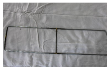
1c. Molde de estructura en alambre
