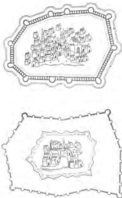
Fig. 6. La dualidad entre ciudad y muralla se desprende de los consejos que MedinaBarba recomienda para fortificar una ciudad antigua rodeada de cercas viejas o que hubiera disminuido su casco urbano; p. 176-177 y 156-157.
